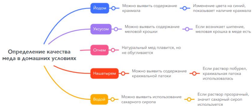
Рис. 1. Блок-схема комплексной проверки меда на его фальсификацию в быту
