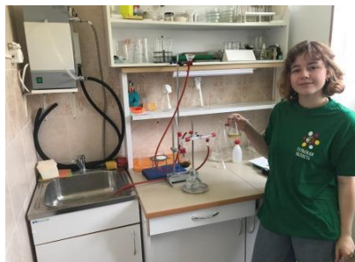
Фото 6. Установка паровой дистилляции для получения гидролата и эфирного масла
