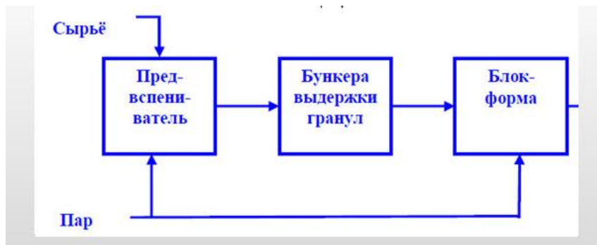
Рисунок 2. Схема изготовления пенопласта из вспенивающегося полистирола
